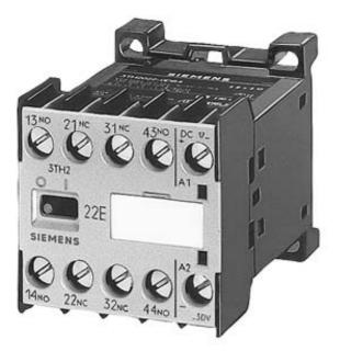
CONTACTOR RELAY 22E EN 50 011 2NO+2NC, SCREW TERMINALS AC OPERATION AC 230/220V 50HZ, 276/264V 60HZ
